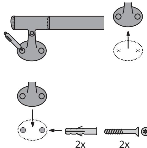
Una vez montadas se presenta el **pasamano** a la pared donde se va a instalar, marcamos las **fijaciones de los anclajes** y, con una broca de 10 de hormigón, hacemos los agujeros correspondientes para meter los tacos en la pared.
