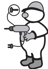
8. A continuación atornillamos todas los **anclajes** a la pared utilizando la punta TORX-40 y una vez atornillado hacemos el ajuste definitivo de los **pasamanos articulados** a los **anclajes a pared**.
